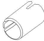
Spoeladapter 8 mm diameter binnenin; 13 mm buitenzijde
